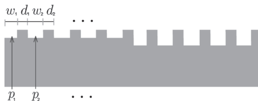
Slika 10. Parametri optimizacije su debljina svake pojedinačne prepreke i rastojanje između susednih prepreka (ukupno 140 parametara). Parametri su varirani u intervalu od 0.2 mm do 8.2 mm.
