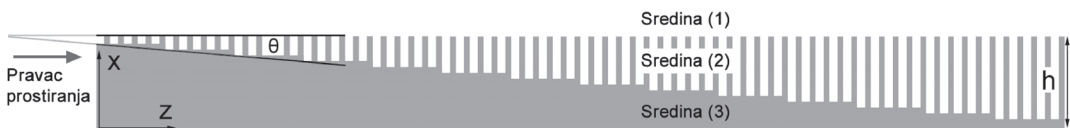
Slika 3. Metamaterijal i okolina se mogu posmatrati kao tri sredine: vazduh iznad prepreka (sredina 1), ćelije metamaterijala (sredina 2) i oblast ispod ćelija metamaterijala od čelika (sredina 3).
