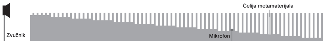
Slika 2. Šema postavke eksperimenta. Zvučnik postavljen ispred strukture emituje talas određene frekvencije. Mikrofonom se meri se akustični pritisak u svakoj ćeliji strukture.
