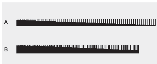
Slika 12. Neoptimizovana struktura (A) i optimizovana struktura (B). Čelije neoptimizovane strukture imaju pravilan geometrijski raspored. Pozicije u metamaterijalima na kojima se lokalizovao zvuk su različite.
