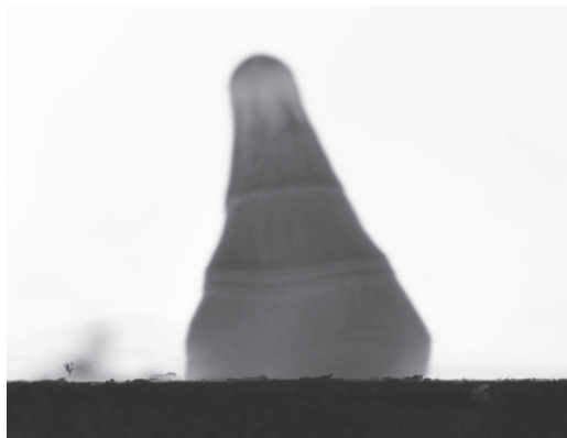
Slika 8. Zaleđena kapljica triprocenatnog etanola koji predstavlja primer odstupanja norme najčešće krajnje strukture zaleđenih kapljica (slika 9) i kod kog nije moguće uspešno izračunavanje H/2r ; sličan primer netipičnog oblika prikazan je i na slici 3C.
