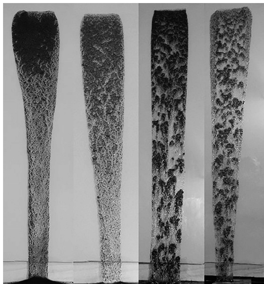
Slika 2. Smeša za uglove 12.3^\circ , 20.3^\circ , 35.2^\circ , 43.2^\circ sa leva na desno, gornji kraj slike predstavlja početak strme ravni
