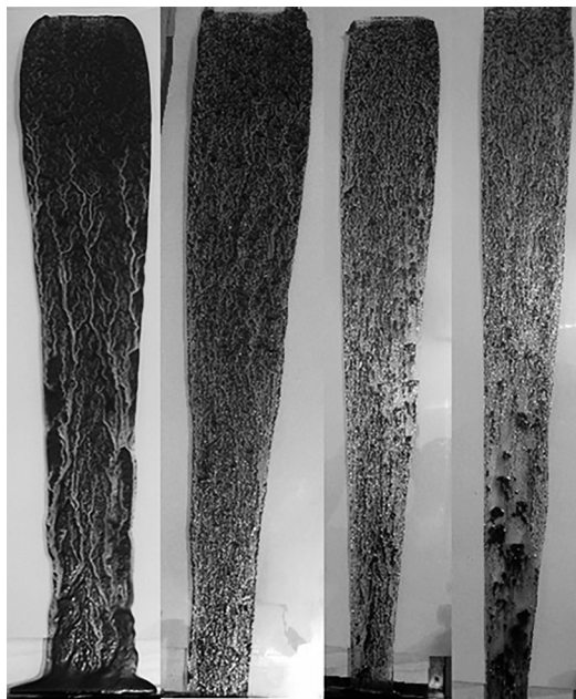
Slika 10. Smeša kafe i suncokreta za uglove 12.3^\circ , 20.3^\circ , 35.2^\circ , 43.2^\circ sa leva na desno
